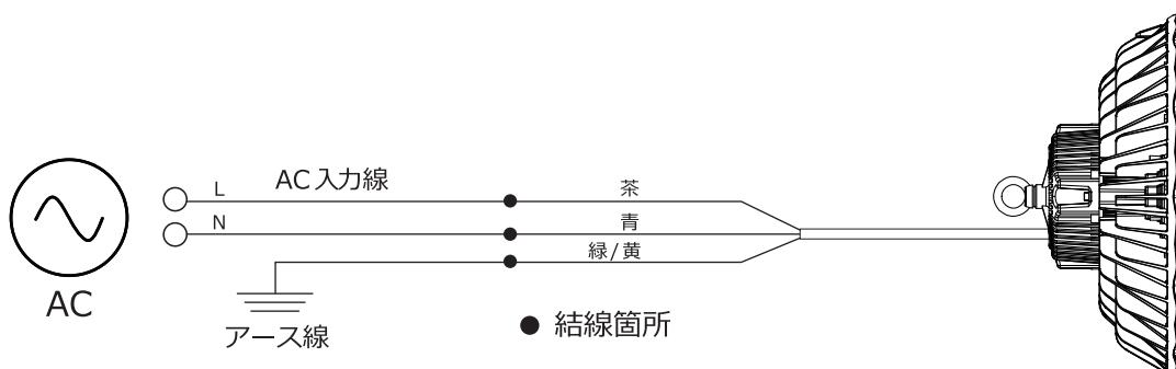
※専用電源は、投光器に取付け及び接続された状態で納品されます。
