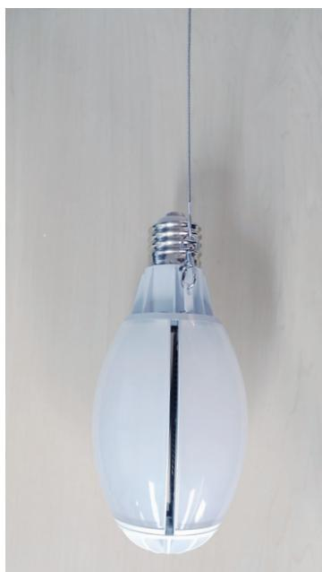
落下防止ワイヤーは、落下防止と共に口金の負担軽減目的としても取り付けいたしますので、必ずピンと張ってください。
