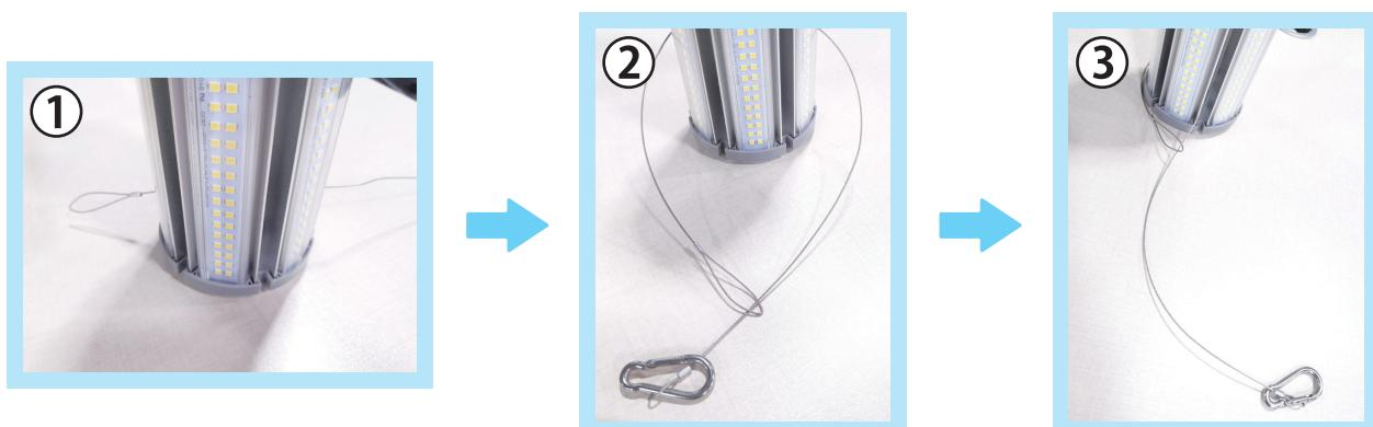
落下防止ワイヤーは、落下防止と共に口金の負担軽減目的としても取り付けいたしますので、必ずピンと張ってください。
