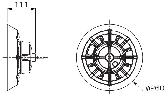
直付け型取付けアダプターの穴位置（付属品）
