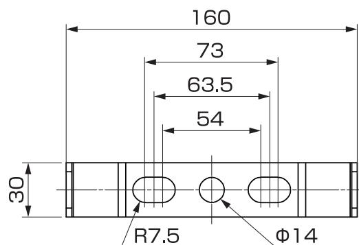
※本体とアダプターを固定する六角ボルトは付属していますが、設置用の六角ボルトは付属していません。（ボルトサイズ：M12 推奨）
